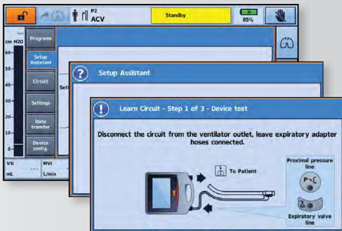
Der zur Verfügung stehende Schlauchtest misst und kompensiert Widerstandsveränderungen im Schlauchsystem. Optimale Beatmung – mit immer richtigem Druck und Flow.
